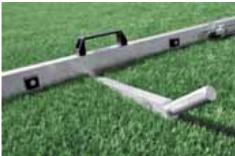
Figura 5. Regla y cuña de Regularidad superficial
